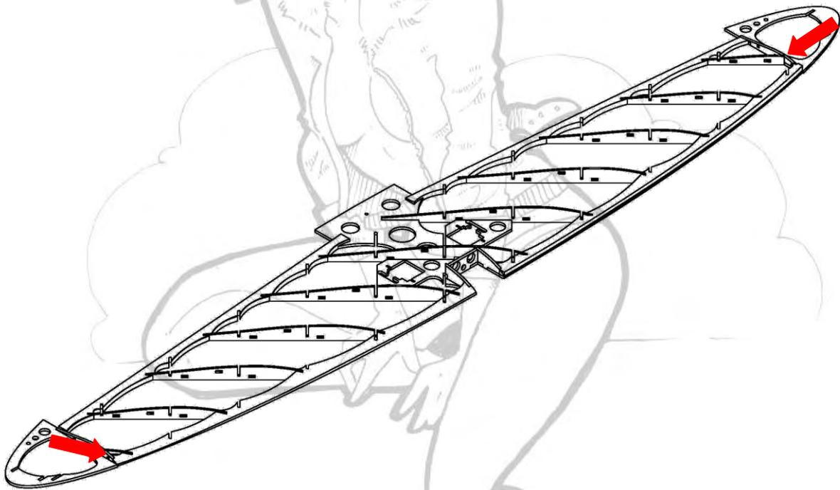
**Wie in der Zeichnung dargestellt die Rippen anordnen. Wieder nicht kleben! Die Rippen aussen, müssen im Bereich der Auflage zur Endrippen 45° angeschrägt werden. (Pfeile)**
