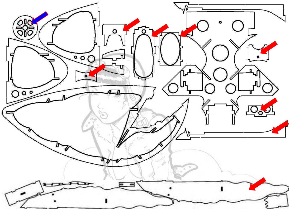
**Aus diesen gekennzeichneten Teilen entsteht der erste Bauabschnitt des Rumpfes.**
