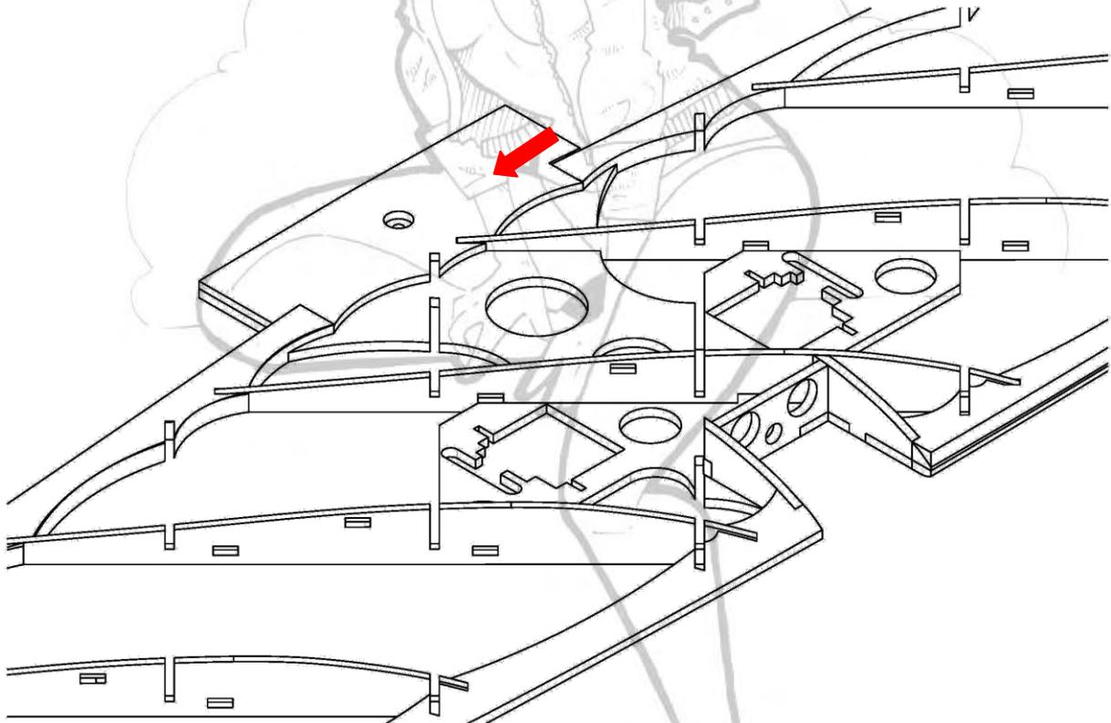
**Dieses Balsa- Teil kann schon angeklebt werden. Position ergibt sich durch die Kontur.**
