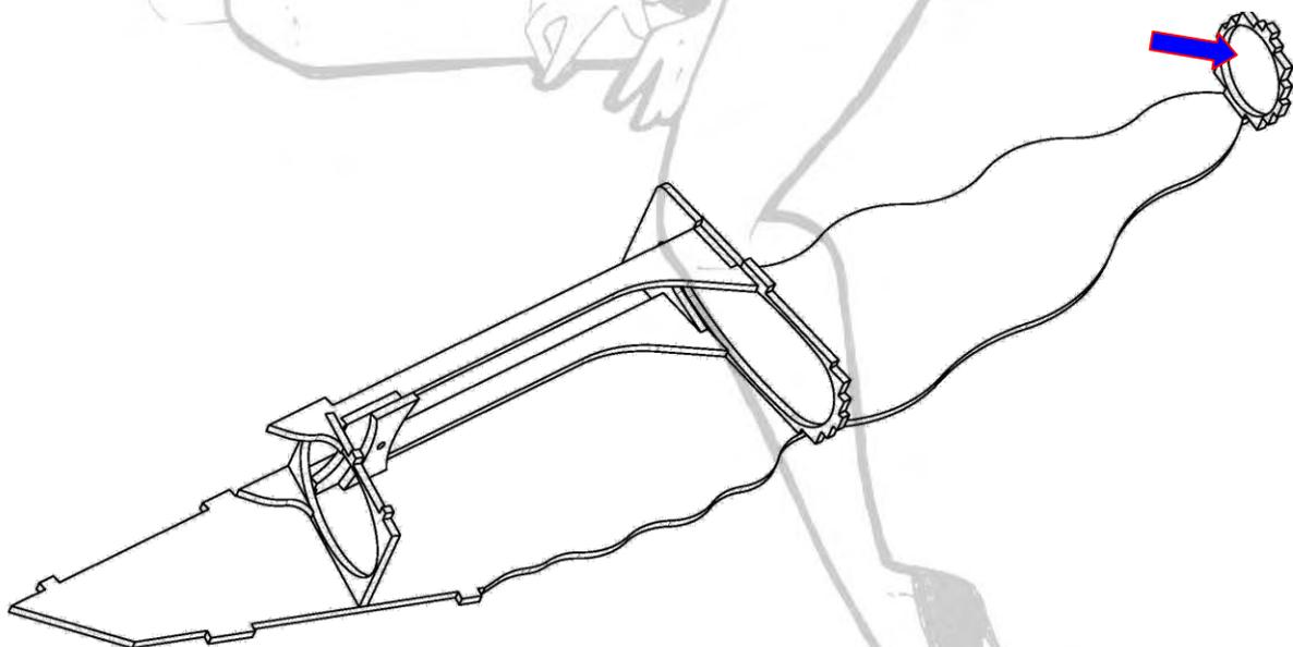
**Die Teile wie hier dargestellt "sauber winklig" anleimen/kleben. Achtung! der erste Spant ist filigran, er wird aber nach anleimen des vorderen Spantes sehr stabil. Evtl. kann der Motorspant als Verstärkung jetzt schon draufgeklebt werden. (Position, blauer Pfeil)**
