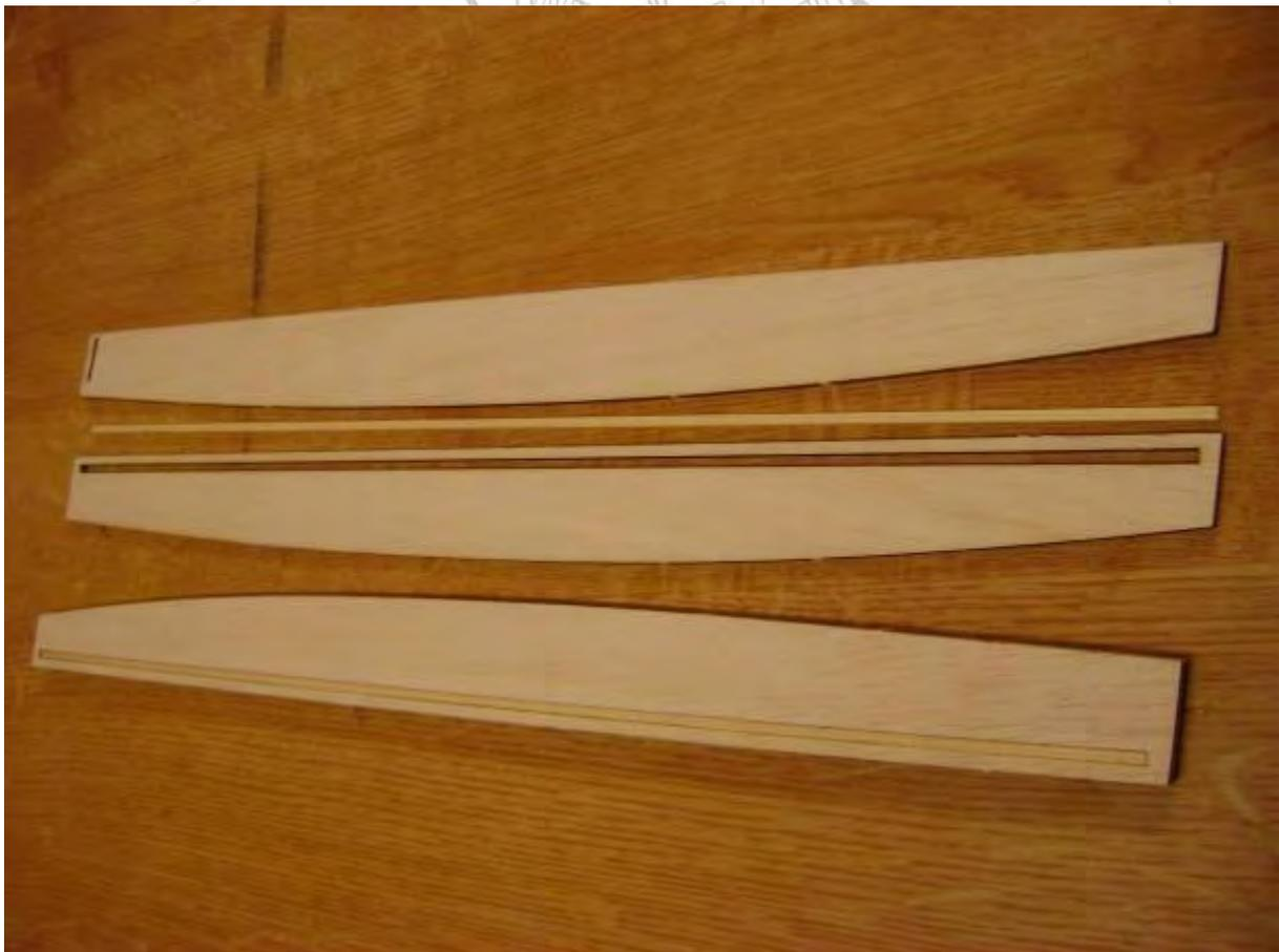
**Wie auf dem Bild dargestellt, Kieferleiste 3X3 kürzen und einsetzen.
