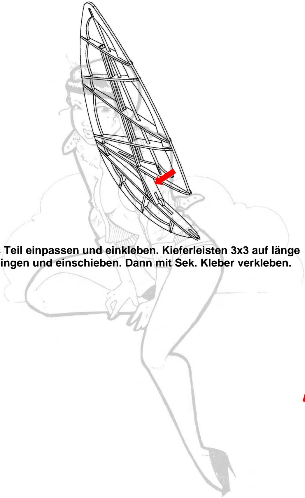
**Das Teil einpassen und einkleben. Kieferleisten 3x3 auf länge bringen und einschieben. Dann mit Sek. Kleber verkleben.**
