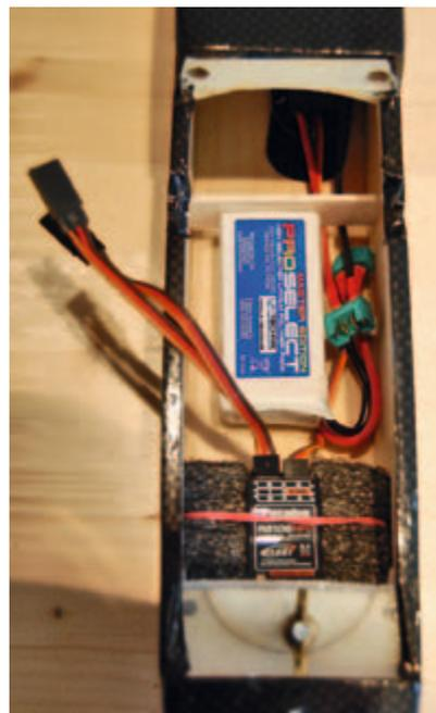
Platzmangel? Nicht im Birdy! Der Rumpf ist schon fast übertrieben geräumig; der Akku wird mit Klettband befestigt. Ein Anschlag aus Balsa sorgt für eine stets einheitliche Schwerpunktlage.
